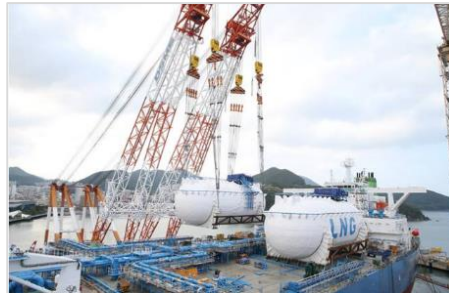
Type-CLNG 연료탱크(탱커에 탑재) ※ 세계최초 고망간강 소재 연료탱크 탑재식 행사
