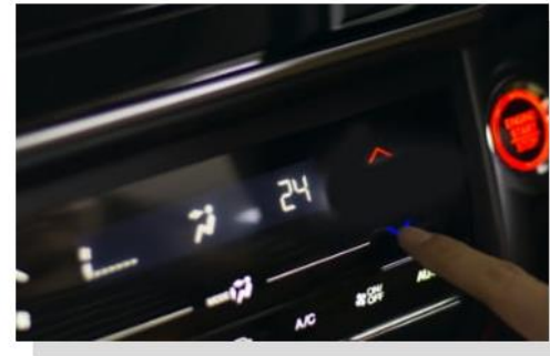
터치식 공조기 (HVAC)
