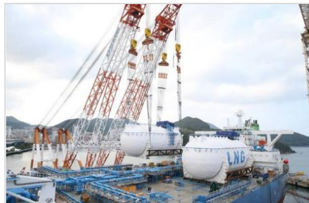
Type-C LNG 연료탱크 (탱커에 탑재) ※ DSME 세계최초 고망간강 소재 연료탱크 탑재식 행사
