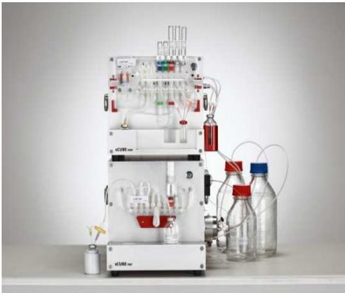
**\* 자동합성장치: 차폐된 공간에서 방사성의 약품을 원격으로 합성 정제 제제 등의 생산 프로세스를 통해 GMP수준의 의약품을 대량으로 생산하는 하드웨어 시스템**
