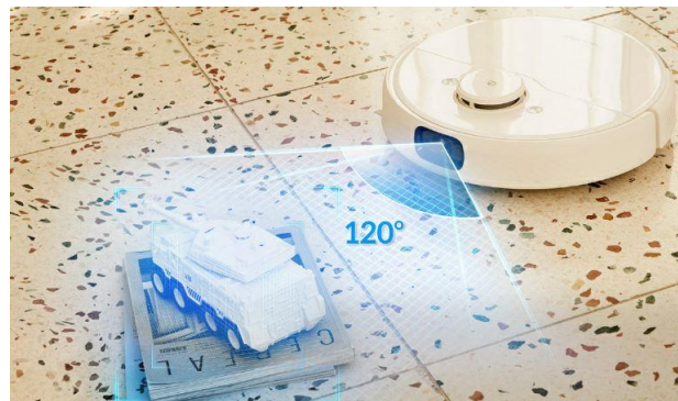
그림 5. 전면 3D ToF (장애물 감지, 회피)
